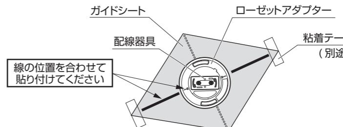
③ガイドシートの線位置にランプ本体の▲を合わせながら、引掛端子を配線器具に差し込み、時計方向(右)へ少しだけゆっくり回し、止まれば完了です。(SCL20 シリーズのみ)
