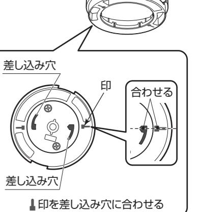
②ガイドシートの線位置を、ローゼットアダプターの [印] 位置に合わせます。その後粘着テープなどで、ガイドシートの 2か所を天面に仮止めしてください。
